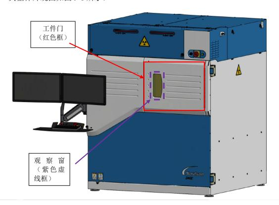
图 9-1 X 射线 3D 检测仪整体外观示意图
