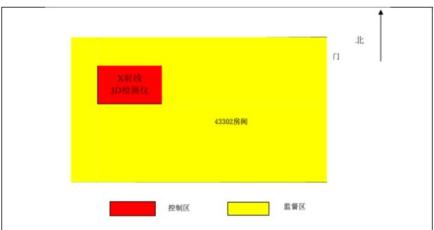
图 10-1 X 射线 3D 检测仪平面布局及分区管理图
