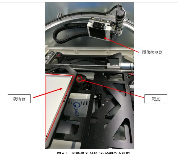
图 9-3 拟购置 X 射线 3D 检测仪内部图
