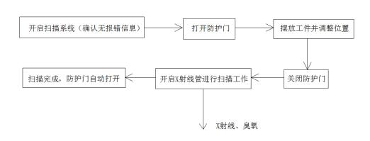
图 9-4 工作流程及产污环节分析图
