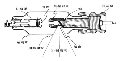
图 9-2 典型 X 射线管结构图
